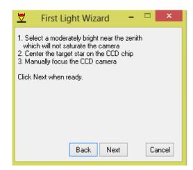
Dans un premier temps il s'agit de pointer le télescope vers une étoile de magnitude moyenne (autour de 5) et proche du zénith pour s'affranchir le plus possible de la turbulence, de la centrer (à peu près) sur le capteur et d'utiliser la raquette de commande du focuser (Jog) pour réaliser une première mise au point grossière. Cliquer sur Next
