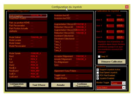
Celui-ci étant supposé connecté, EQMOD propose un paramétrage par défaut que l'on peut modifier en cliquant sur la commande et en remplaçant par le boutant choisi. Valider avec le bouton Confirmer changement
